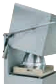
*Le capot s'incline vers le haut à l'arrière de sorte que la vapeur se décharge par l'arrière de la machine plutôt que sur l'avant de la pièce, devant l'opérateur.*
