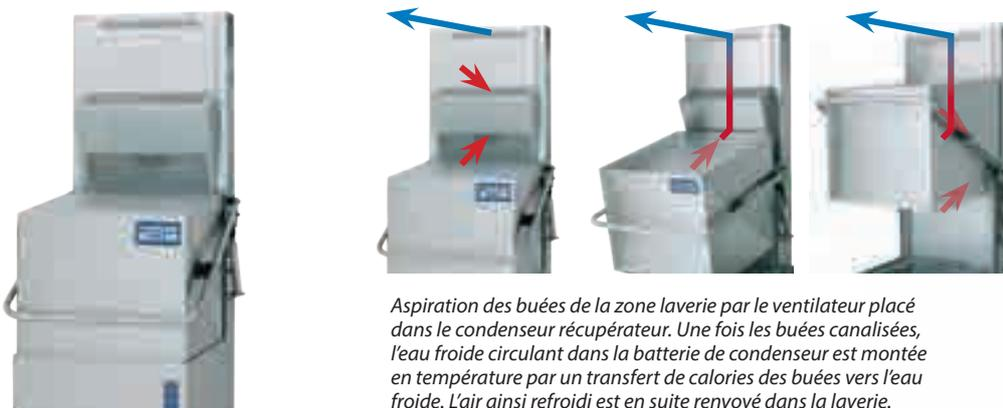
*Aspiration des buées de la zone laverie par le ventilateur placé dans le condenseur récupérateur. Une fois les buées canalisées, l'eau froide circulant dans la batterie de condenseur est montée en température par un transfert de calories des buées vers l'eau froide. L'air ainsi refroidi est en suite renvoyé dans la laverie.*
